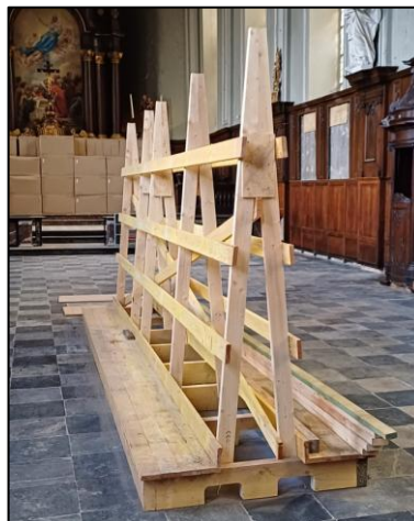
Figure 33 : Exemple de chevalet de manutention – Église Notre-Dame des Récollets de Verviers.
