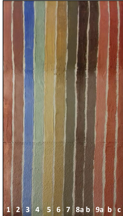
Figure 21 : Échantillonnage de peintures à la chaux (1. Ocre rouge ; 2. Terre de Sienne brûlée ; 3. Bleu outremer artificiel ; 4. Terre verte ; 5. Ocre jaune ; 6 : Terre de Sienne naturelle ; 7 : Terre d'Ombre naturelle ; 8a et b : Terre d'Ombre brûlée ; 9a, b et c : Rouge anglais).
