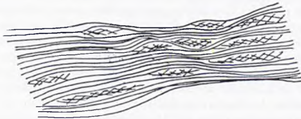
Fig. 6. — Molécules de cellulose XXXXXX Molécules d'hémicellulose.
