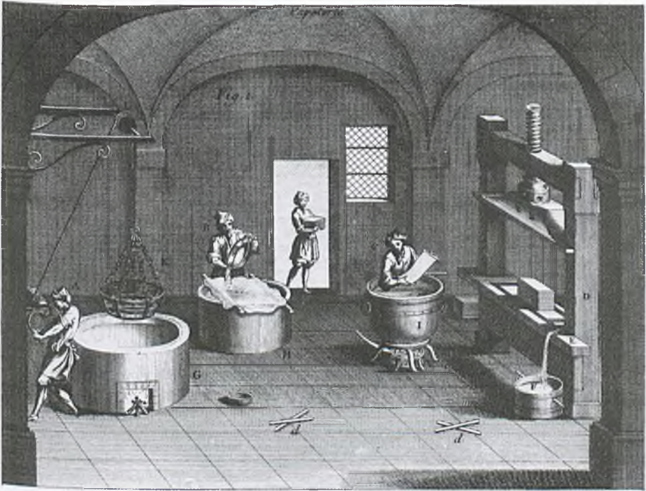
Afb. 8. Lijmen (bestrijken) van papier (uit: J.J. de Lalande, Art de faire le papier , Parijs, 1761, Afb. XII.).
